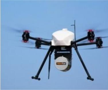
AltiGator y YellowScan han lanzado una combinación de un Lidar UAS de peso ultraligero permitiendo levantamientos UAV centimétricos en las zonas urbanas, en concordancia con la mayoría de las regulaciones. El sistema Lidar ultraligero autónomo YellowScan Surveyor está empotrado en el UAV multirotor OnyxStar XENA, el cual es la última generación profesional de UAV diseñado por AltiGator.
