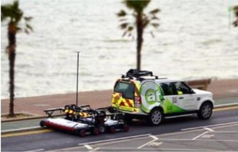
Catsurveys Group ha creado un innovador proceso de georreferenciación y sincronización, lo que permite la combinación de datos generados usando un sistema de vehículo remolcado - Mobile Ground Penetrating Radar (MGPR) y un GPS- creando máxima precisión y producción. El sistema MGPR puede grabar hasta 50 kilómetros lineales por día, requiriendo Gestión de Tráfico limitado.
